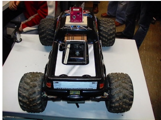
Bild 6-27 am Fahrzeug angebrachte Kamera
