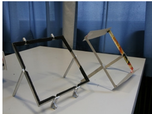
Bild 6-14 Rechnerhalterung als Prototyp und fertiges Bauteil
