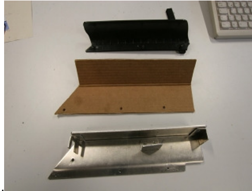
Bild 6-13 Seitenschweller im Original, Prototyp und als fertiges Bauteil
