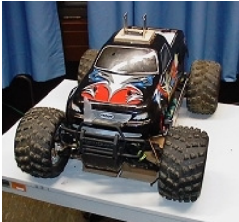
Bild 6-26 Fahrzeug mit Kamerahalterung
