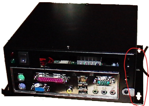
Bild 6-6 Gehäuse mit zu entfernenden Teilen (rot markiert)
