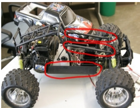
Bild 6-11 Fahrzeug mit zu entfernenden Teilen (rot markiert)
