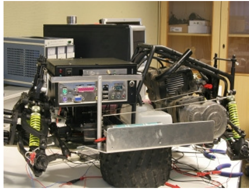
Bild 6-16 Fahrzeug mit eingesetzten Hauptrechner
