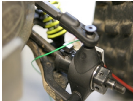
Bild 6-19 Hall-Sensor an der Hinterachse
