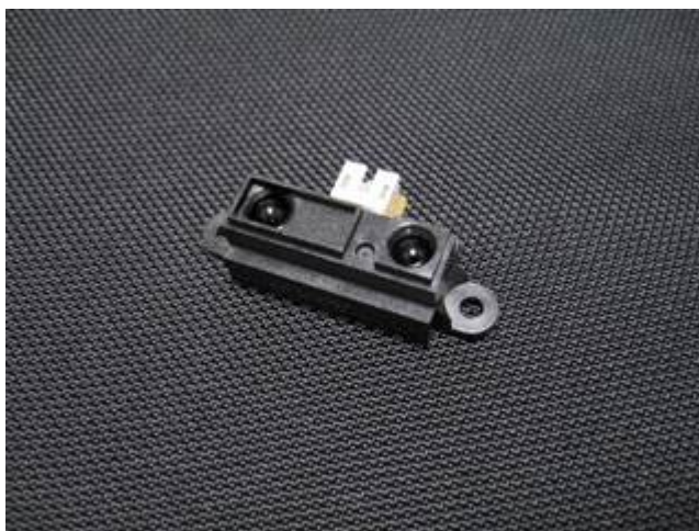
Bild 3.4: Sharp Infrarotsensor GP2D12
